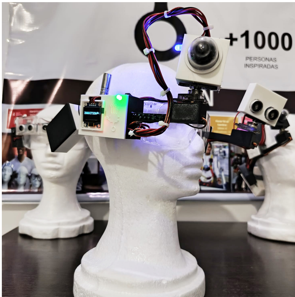
Prototipo v5 de seebotic-innvition (sistema de reconocimiento de entornos).
